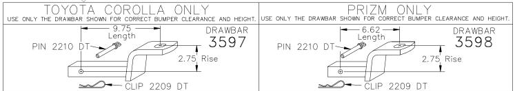
USE ONLY THE DRAWBAR SHOWN FOR CORRECT BUMPER CLEARANCE AND HEIGHT. DRAWBAR MUST BE USED IN THE RISE POSITION ONLY.
